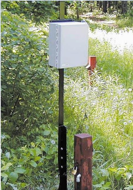
Телеметрическая система **STS 9100 Edge - GSM** предназначена для удаленного автоматического контроля уровня, температуры и проводимости (солености) воды в скважинах, пьезометрах, резервуарах и открытых водоемах (реках, озерах, водохранилищах, морях). Система работает в зоне покрытия сотовой сети GSM.
